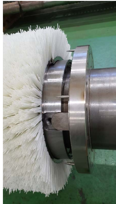
조립 Flange 체결
